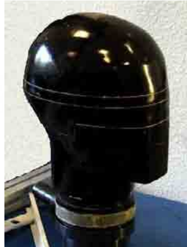
Figure 10 : forme globale de la « fausse tête » décrite dans la norme ECE 22
