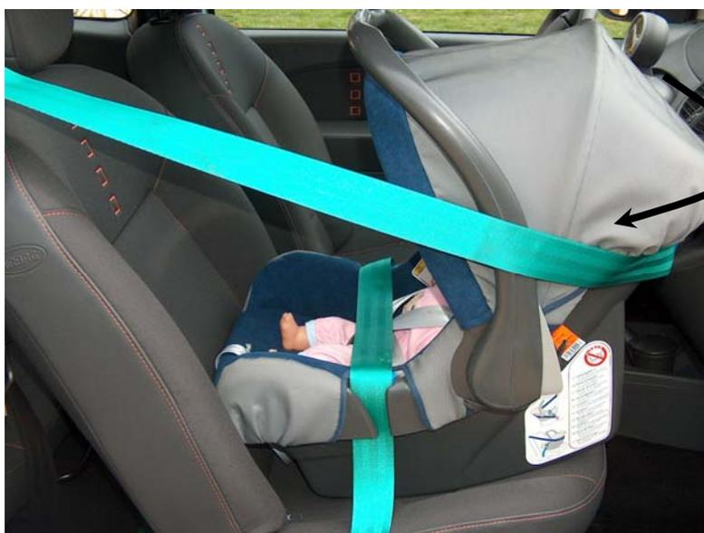
Photo n° 23 : Ramener la ceinture diagonale derrière le DRE et vérifier le passage dans les guides arrière
