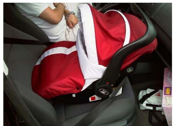
Photo n° 18 : siège mal installé avec une housse masquant les guides supérieurs
