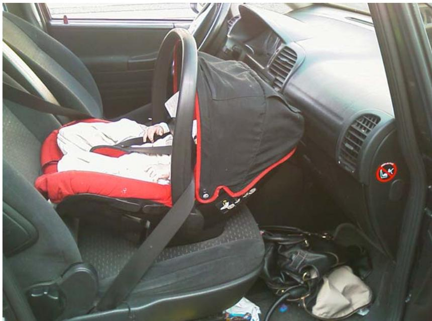
Photo n° 14 : DRE mal installé en place avant avec un airbag non désactivable !
