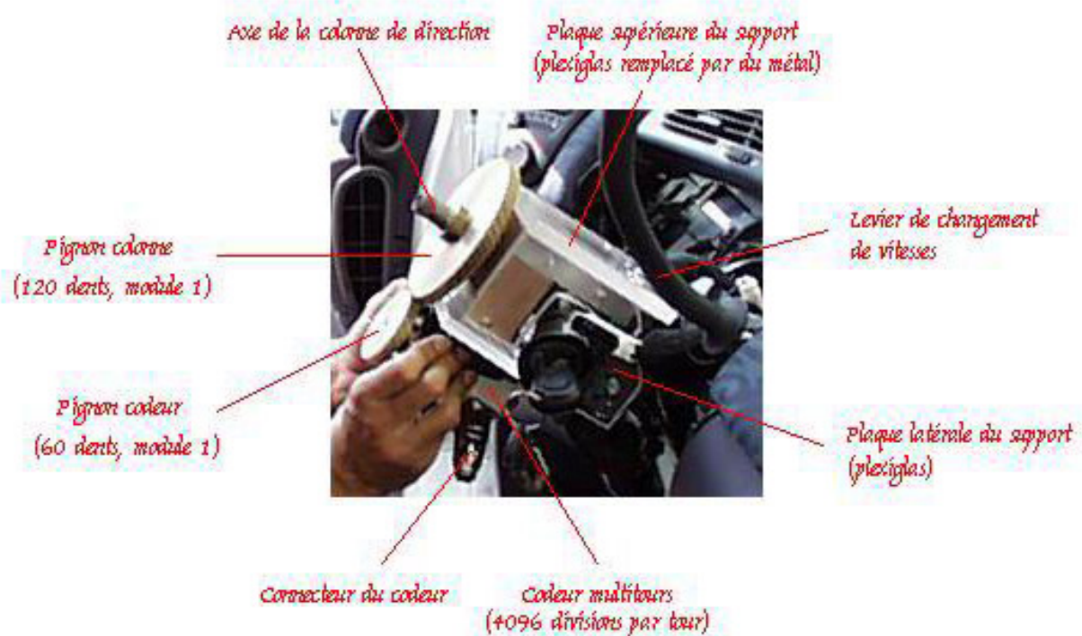
Figure 15 : Implantation du capteur d'angle volant sur l'espace de l'ENSM
