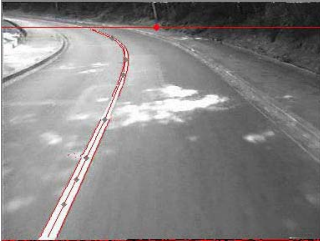
Figure 6 : Exemple de détection de marquage au sol réalisé au CAOR
