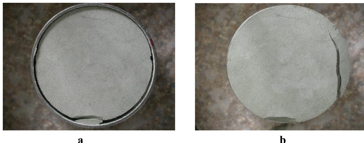
**Figure 4.4.1 : Echantillon intact de Marne bleue d'Argenteuil : a) après séchage, b) après imbibition ( $w > w_r$ )**
