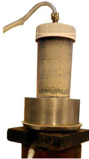
Figure 2.4.4. Echantillon préparé pour la mesure de conductivité thermique
