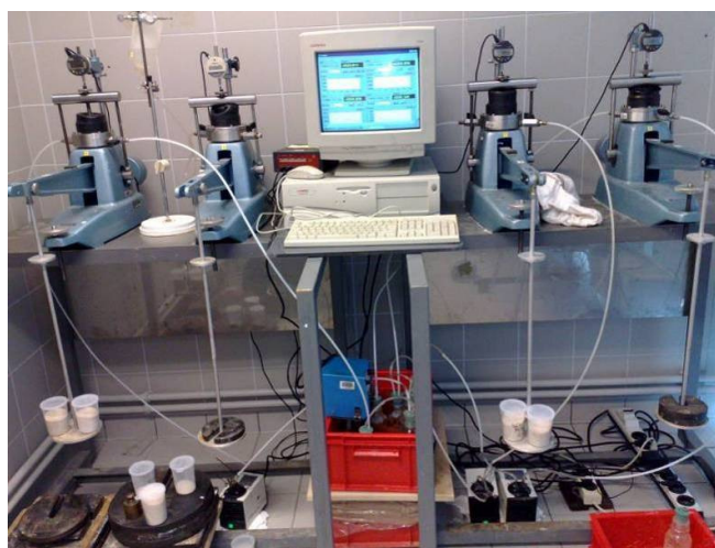
Figure 2.4.1. Quatre essais oedométriques à succion contrôlée
