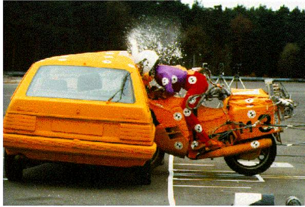
Figure 3 : Reconstruction expérimentale d'un accident de motocycliste.
