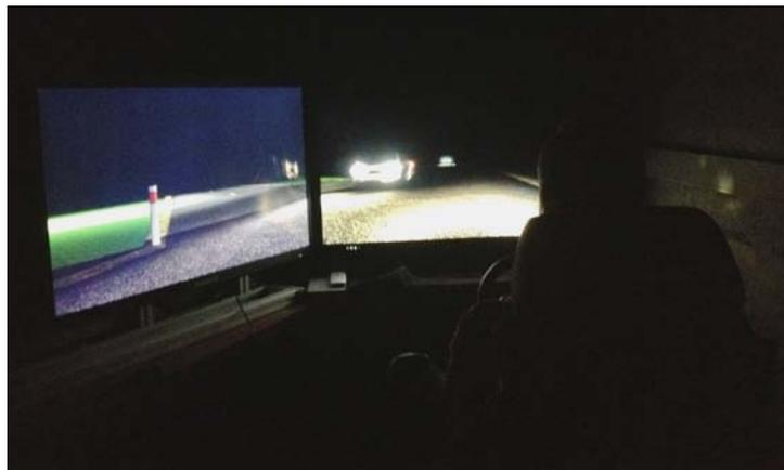
Photo 2 : Dispositif expérimental, en cours d'expérimentation en condition nocturne (vue de derrière le participant)
