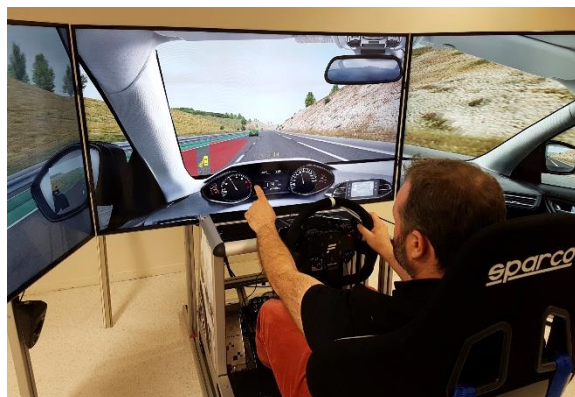
Streetlab a utilisé un simulateur dont la sous-traitance a été confiée à Octal SA, leader mondial du marché. Ce simulateur a été paramétré pour tester les situations d'angle mort et de freinage d'urgence.
