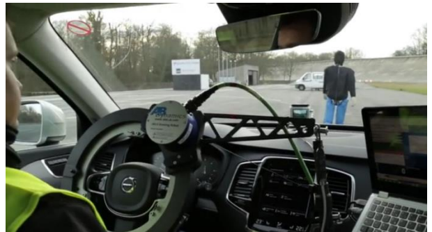
Le laboratoire UTAC CERAM installe dans les véhicules qu'il teste des robots de conduite pour répéter à l'identique trajectoires et vitesses. Il utilise des mannequins articulés pour figurer de façon réaliste les piétons que la voiture doit être capable de détecter en toutes situations.
