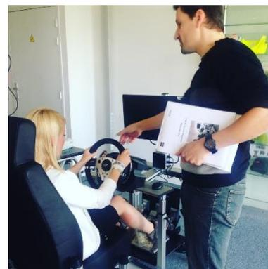
Equipé d'un volant, de trois pédales et d'un écran, le banc d'évaluation est entièrement réglable (hauteur du volant, assise...) à la main. Le bloc assise peut même être retiré pour être remplacé par un fauteuil roulant.
