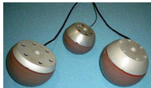
Figure 143. Tête hémisphérique utilisée lors des impacts expérimentaux.
