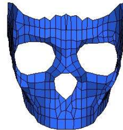
La face (369 éléments coque)
