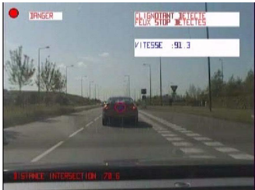
La dernière image correspond au rejeu du même scénario mais nous avons simulé cette fois-ci une vitesse trop élevée de notre véhicule (91 kms/h) et une distance de sécurité trop faible. Le système de signalétique embarquée active alors un signal rouge sur le tableau de bord du véhicule.
