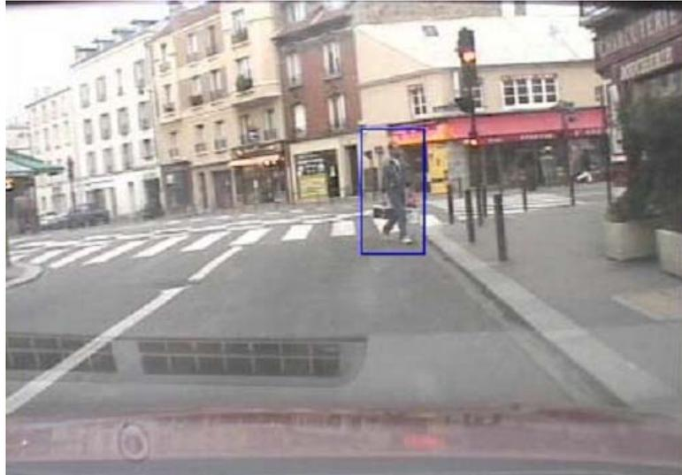
Détection de piéton à partir d'une caméra mobile embarquée. (on observe dans l'image le reflet du tableau de bord dans le pare brise)
