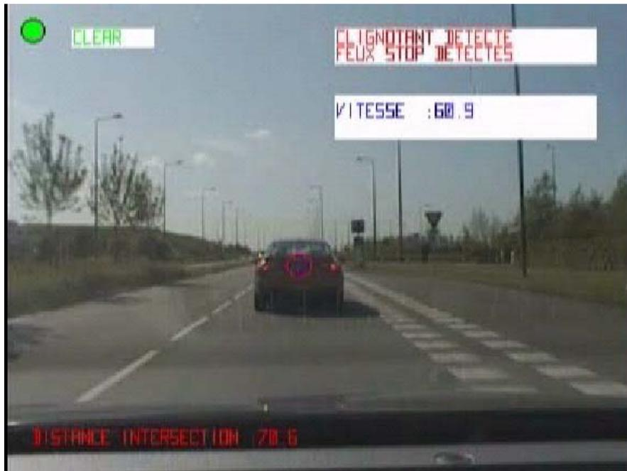
Les feux stops qui s'allument au moment du freinage du véhicule précédent sont détectés à leur tour. La vitesse de notre véhicule lue sur le bus CAN est affichée. La distance de sécurité déterminée par le radar est respectée et le signal vert est activé sur le tableau de bord de notre voiture.
