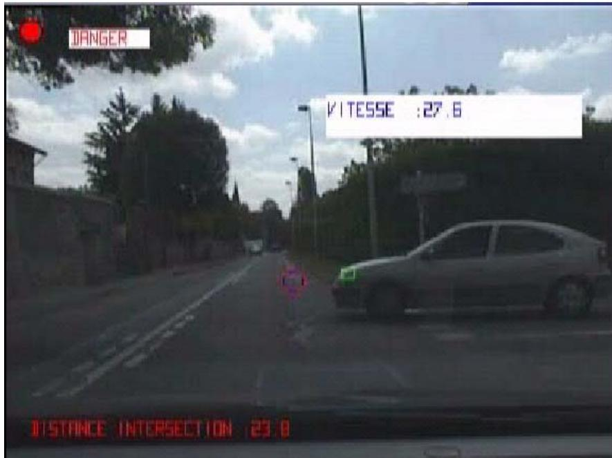
Annnonce d'une intersection avec panneau stop grâce à la technique de l'horizon électronique et surveillance par vision du véhicule à l'arrêt.
