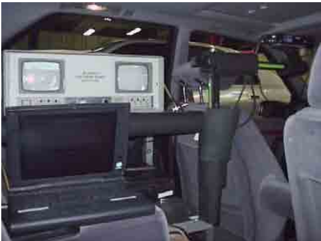
Figure II.15 : Caméra "scène" (entre les sièges avant), PC de dialogue et moniteurs vidéo de l'ETS (image oeil à gauche et image scène à droite).
