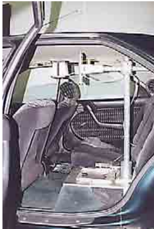
Figure II.5 : Support de l'émetteur magnétique du capteur Ascension.
