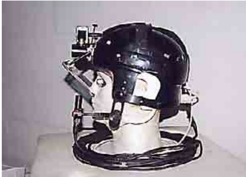
Figure II.4 : Casque de hockey utilisé par l'oculomètre ASL 4000.
