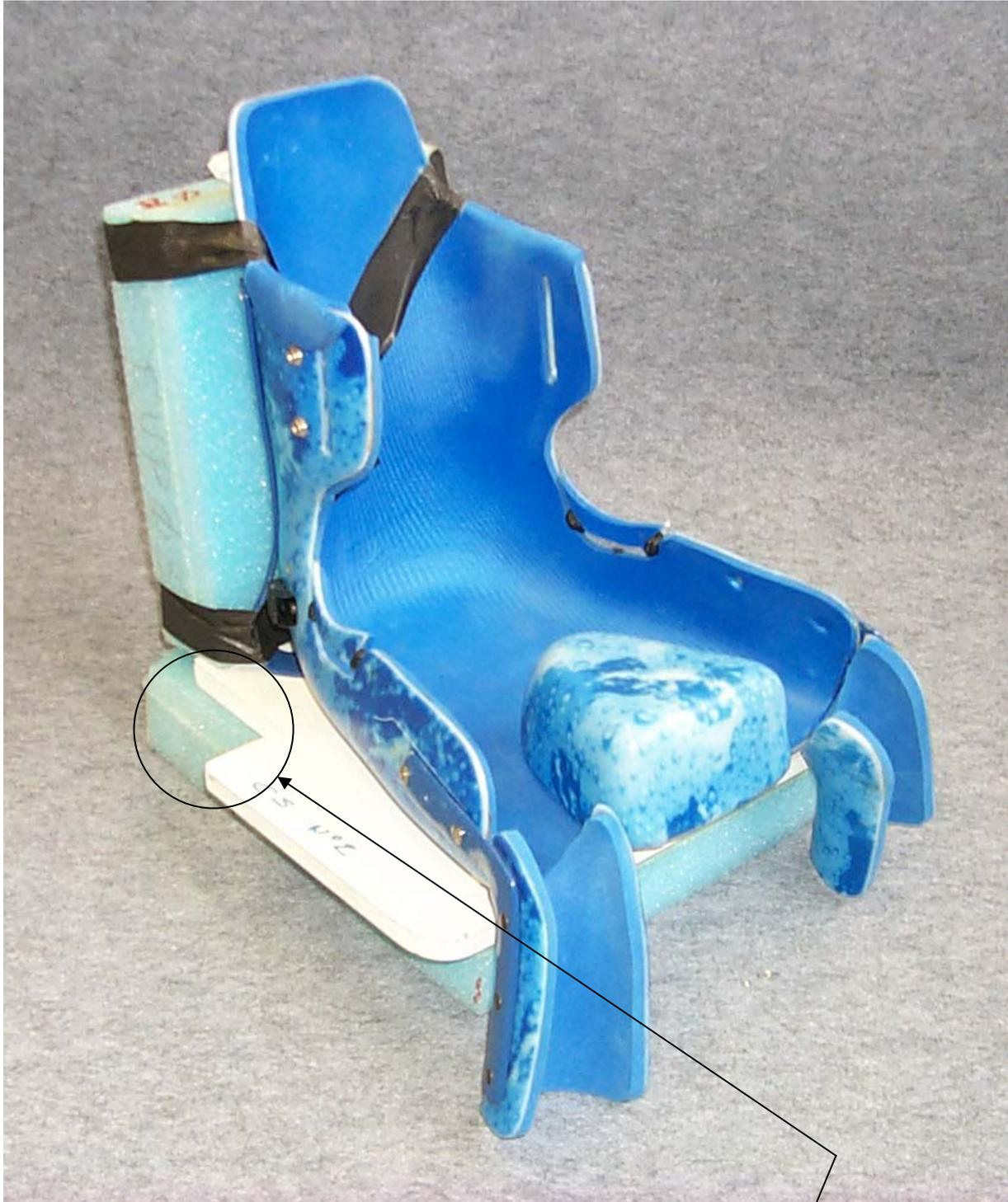
*figure 3 : découpe effectuée sur le socle du corset-siège
