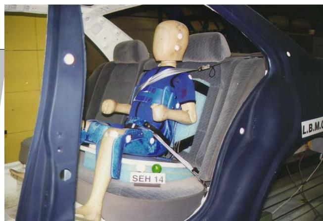
figure 9 : essai 14 ; même configuration que l'essai 13 mais le plastron sert de maintien orthopédique statique en position assise et non de retenue en cas de choc
