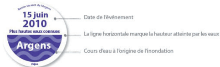
Normalisation des repères de crues
