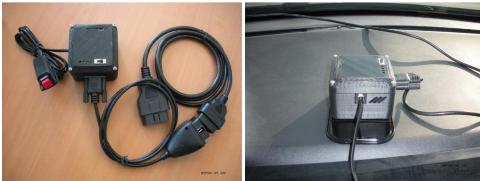
Graphique 1. a) boîtier enregistreur Micro-iBB, fourni par l'ÉTS, et b) boîtier collé sur un tapis antidérapant sur le tableau de bord
