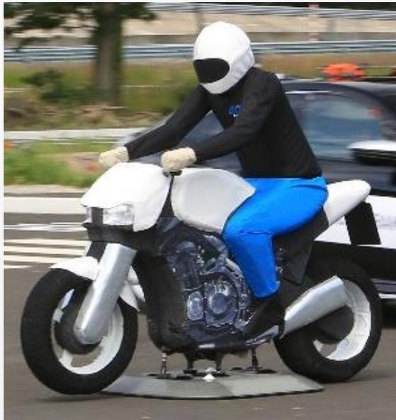
Plateforme avec cible deux-roues motorisé Européen développé avec les projet MUSE
