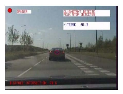
La dernière image correspond au rejeu du même scénario mais nous avons simulé cette fois-ci une vitesse trop élevée de notre véhicule (91 kms/h) et une distance de sécurité trop faible. Le système de signalétique embarquée active alors un signal rouge sur le tableau de bord du véhicule.
