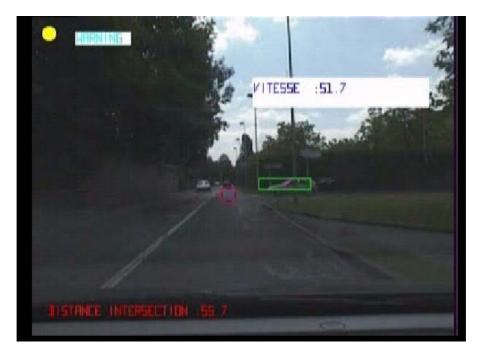
Annonce d'une intersection avec panneau stop grâce à la technique de l'horizon électronique et surveillance par vision du véhicule à l'arrêt.
