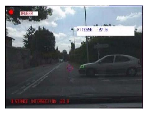
Annonce d'une intersection avec panneau stop grâce à la technique de l'horizon électronique et surveillance par vision du véhicule à l'arrêt.
