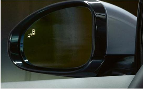
Figure 3 : Interface standard de type Blind spot
